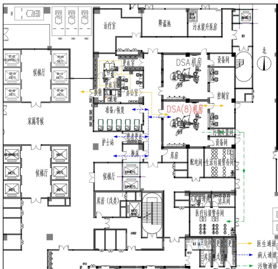
图 3-1 人流物流路径走向示意图
